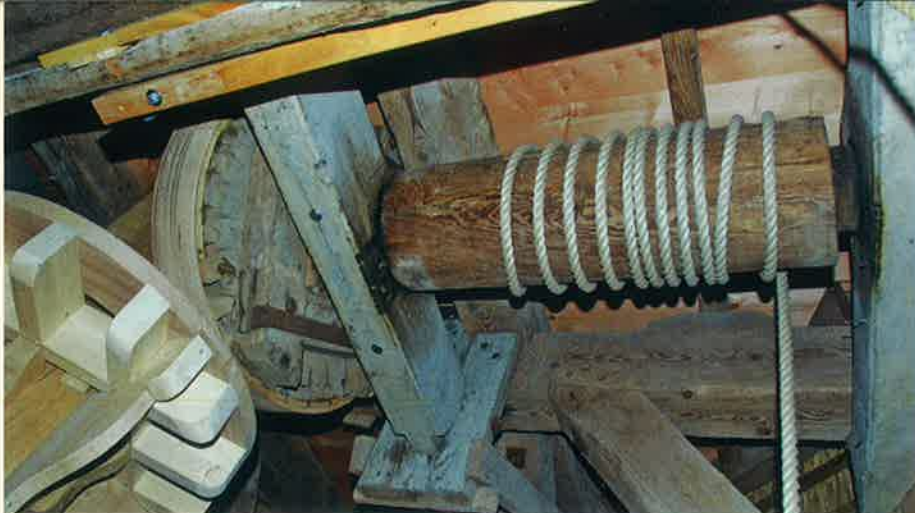
▲De rol van het luiwerk in de molen van 't Zand heeft een ongebruikelijk grote diameter: waarschijnlijk een winderijrol uit de zaagmolentijd (foto H. Noot, 21 april 2014).
