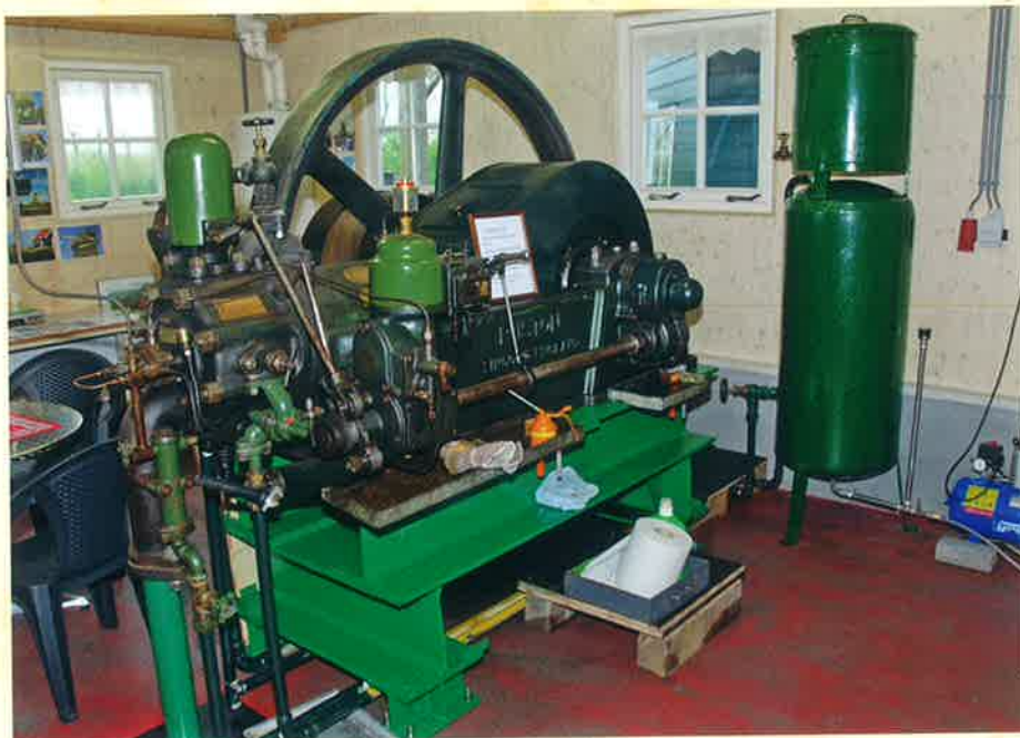
▲ De Rustonmotor die nu de maalstoel onder in de molen aandrijft; rechts de luchtketels voor het starten van de molen (foto H. Noot, 21 april 2014).
