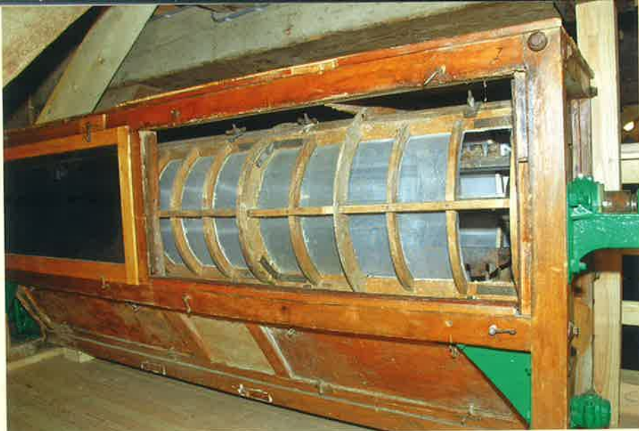
▲ De centrifugaalbuil op de halve zolder (foto H. Noot, 21 april 2014).
